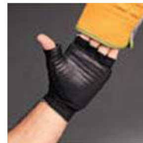
12.1.attēls. Vibrāciju absorbējoši cimdi un puscimdi
