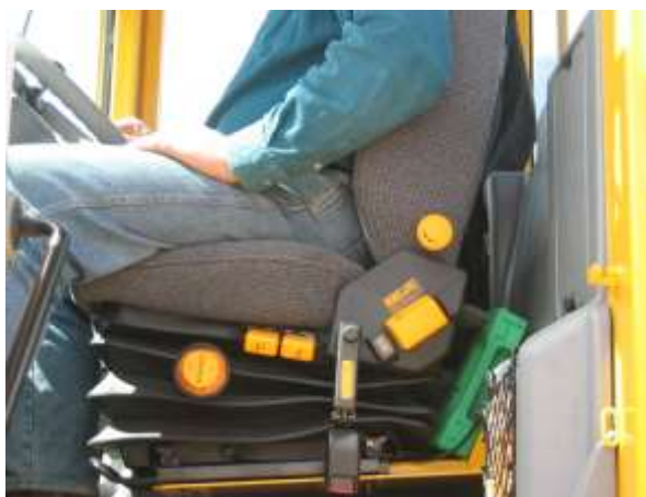
9.attēls. Vibrāciju amortizējošs transporta līdzekļa vadītāja sēdeklis
