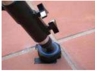
11.3.attēls. Vibrācijas dzēšana, izmantojot gumijas paliktņus zem iekārtas balstiem
