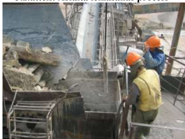
3.4.attēls. Akmens drupināšanas process
