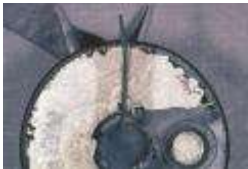
13.attēls. Bojāts aprīkojums (slīpriņa)
