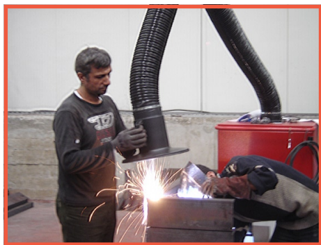
Individuālo aizsardzības līdzekļu nelietošana, atrodoties metināšanas darbu veikšanas vietā, var būt acu bojājumu cēlonis
