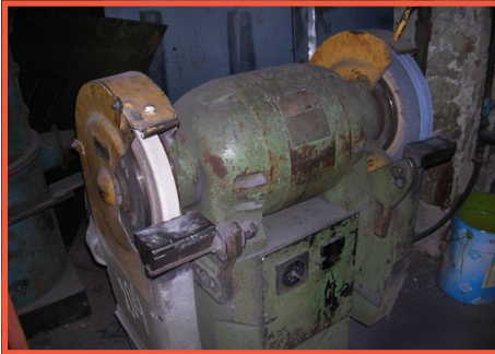
Drošības prasībām neatbilstoša slīpripa ar demontētu drošības vairogu un bez avārijas apturēšanas pogas ir bīstama
