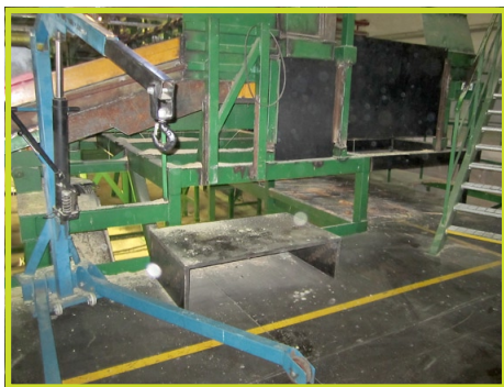
Speciālu pacelēju izmantošanu smagu detaļu pārvietošanai ievērojami samazina gan ergonomiskos, gan nelaimes gadījumu riskus
