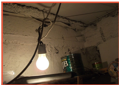
Valējas kvēlspuldzes izmantošana metālapstrādes darbos var izraisīt sprādzienu vai ugunsgrēku
