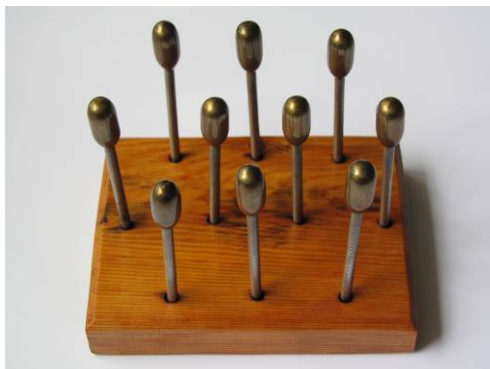
25. attēls. Metāla formas MŽK pagatavošanai ar iemērkšanas metodi
