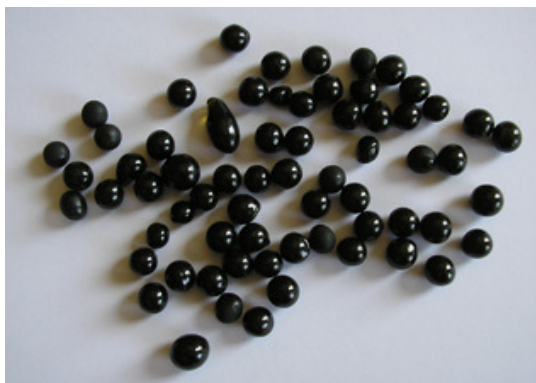
29. attēls. Ar pilināšanas metodi iegūtās MŽK ar SBE 2 saturošu sastāvu
