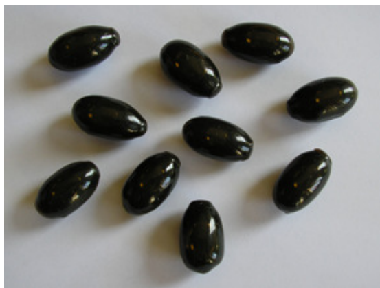
27. attēls. Ar iemērkšanas metodi iegūtās MŽK ar SBE 2 saturošu sastāvu
