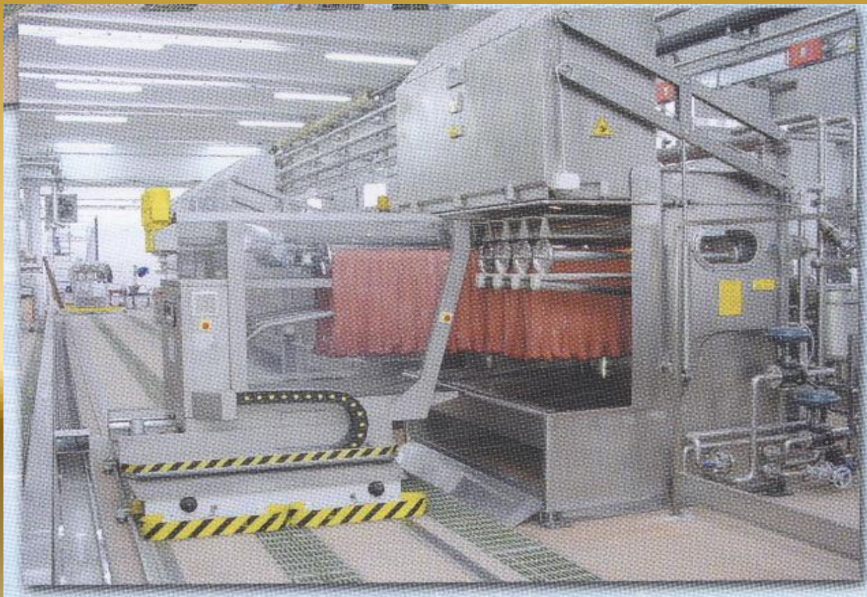
Robotizēta dziju krāsošanas līnija TMB/SV-TRA no OBEM Dyeing Machinery
