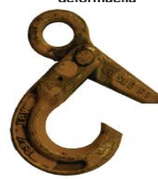
Bojāts āķa aizslēgs, vai tā nav vispār.
