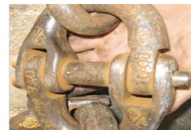
Savienojuma pirksts neturas vietā (nolietojums)
