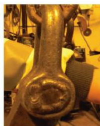
Metināta šuve. Ceļšanas komponentu metināšana nav atļauta !
