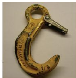
Pārslodze, izliekumi, deformācija
