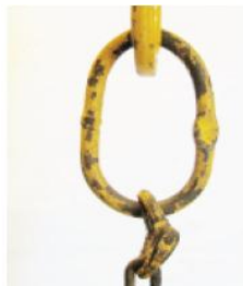
Pārslodzes izraisīta gredzena deformācija
