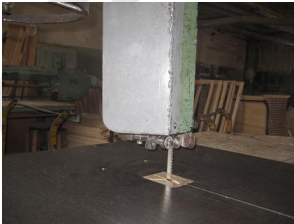
Lentzāģis, kas tiek izmantots figūru izzāģēšanai, nav aprīkots ar aizsargu
