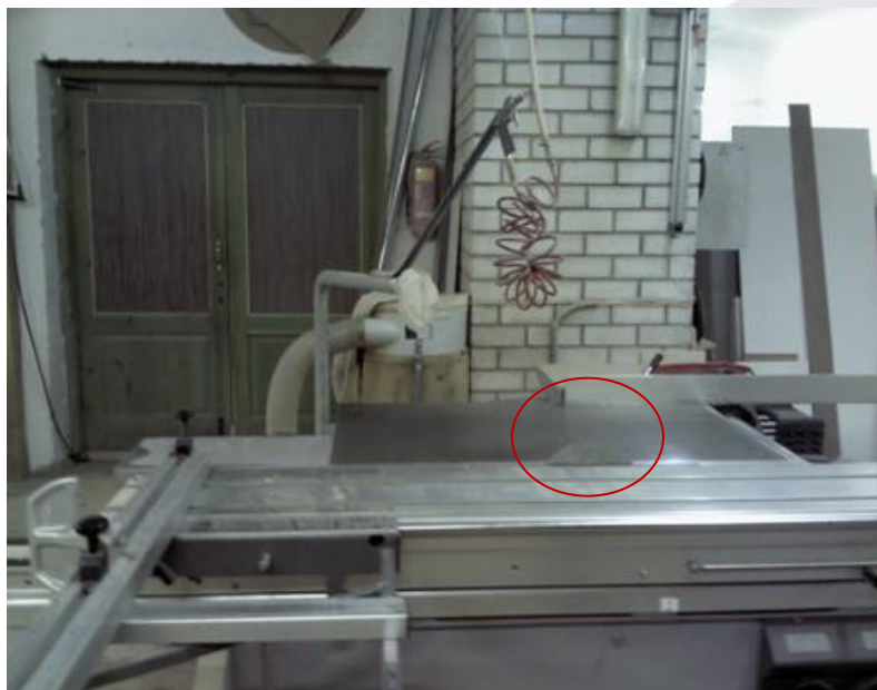
Iekārtas Altendorf 92 zāgripai noņemts aizsargs
