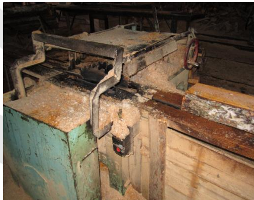
Zimerzāģa kustīgās daļas nav aprīkotas ar aizsargiem
