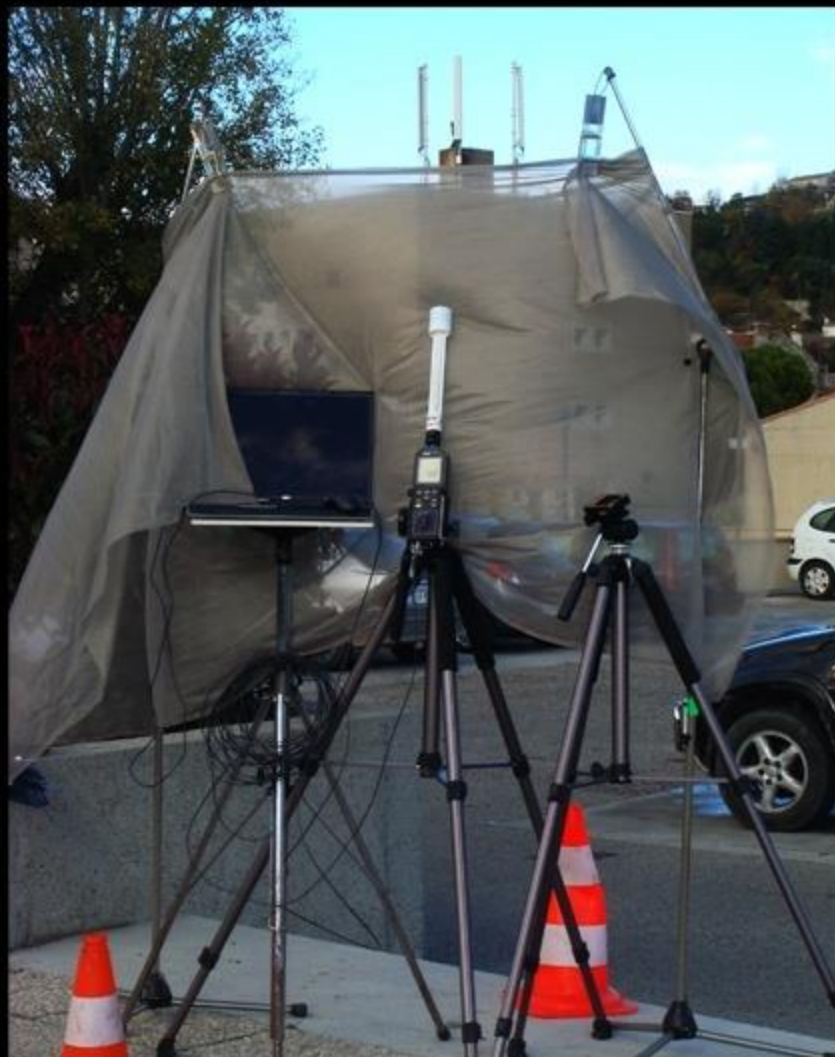
Sonde isotropique 100 kHz - 2500 MHz - liaison fibre optique - intervalles \Delta T 2" - distance 70m
