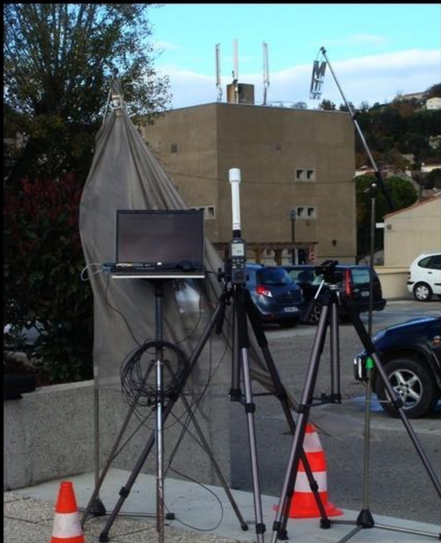
Sonde isotropique 100 kHz - 2500 MHz - liaison fibre optique - intervalles \Delta T 2" - distance 70m
