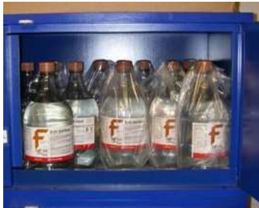
Pareiza korozīvu vielu (skābju un bāzu) uzglabāšana
