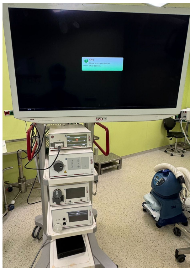
1.2. attēls. System Green ICG infrasarkanā diapazona fluorescences attēlveidošanas platforma Richard Wolf GmbH , autora attēls
