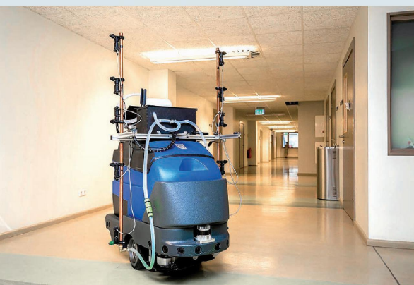
Rīgas Tehniskās universitātes zinātnieku radītais uzkopšanas robots, pateicoties mākslīgām neironu tīklam, spēj atpazīt un automātiski dezinficēt vertikālas virsmas. Foto no Rīgas Tehniskās universitātes arhīva
